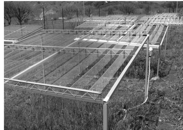
Рис. 1. Конструкції для регулювання кількості, збору та перерозподілу опадів
